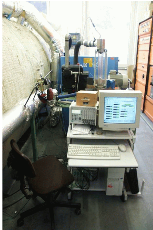
Bild 1: Versuchsstand für Energiespeichersystem mit ungekühlter Druckluft im Institut für Tribologie und Energiewandlungsmaschinen
